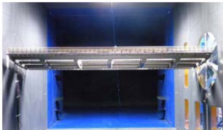
Gambar 4. Model gelagar pengaku dalam terowongan angin (Diana and Flammenghi 2012)
