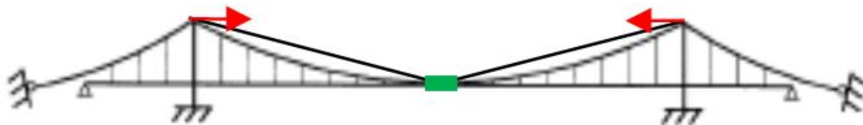
Gambar 3. Sistem klem kabel utama ganda
