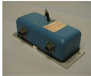
Gambar 9. LVDT sistem rol – pegas.
