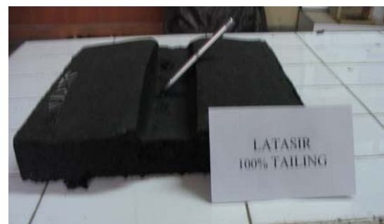
Gambar 7. Hasil pengujian ketahanan terhadap alur pada campuran Latasir dengan 100% tailing
