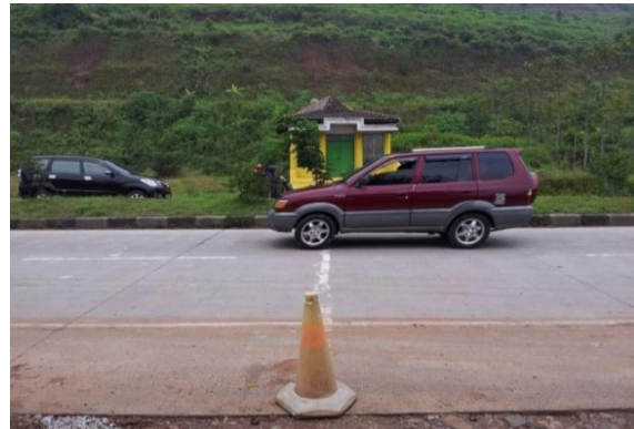
Gambar 5. Ilustrasi pengambilan data waktu tempuh kendaraan pada traffic cone kedua
